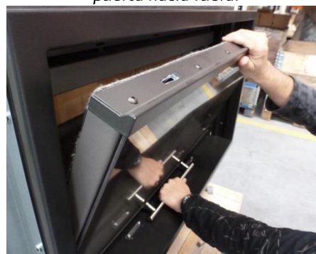
Figura n°39 - Sujetamos la puerta firmemente con ambas manos mientras la abatimos
