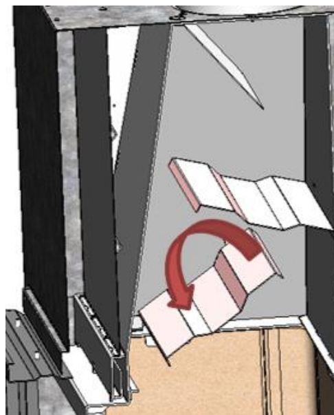
Figura nº30 - Desmontaje del deflector medio Itaca 80
